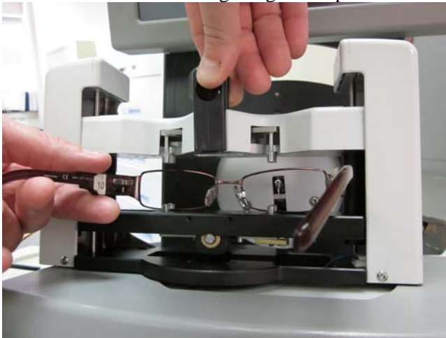
Abb. 3.1a: Einspannen der Fassung.
