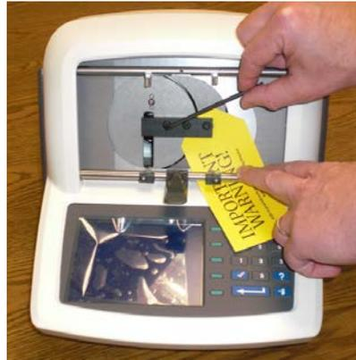
3. Entfernen Sie die drei Schrauben in der Transporthalterung mit dem 9/64-Zoll-Sechskantschlüssel, indem Sie sie gegen den Uhrzeigersinn drehen, bis die Schrauben lose sind.
