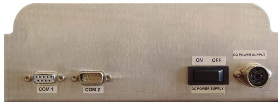
Auf dem Foto oben ist der optionale Ethernet-Anschluss, für den eine RJ45-Buchse verwendet wird, nicht abgebildet. Wenn diese Option vorhanden ist, sind die zwei oben gezeigten Kommunikationsanschlüsse nicht verfügbar.
