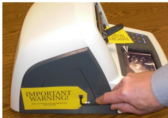
5. Bewahren Sie die Transporthalterung und die Schrauben zur eventuellen späteren Verwendung im Zubehörkit des abtastgerät auf.
