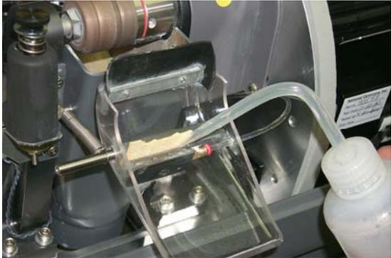
11. Baje la cubierta del conductor de virutas y la unidad de la esponja hasta colocarlos sobre las ruedas pulidoras. Compruebe que los puntos de la esponja encajen en las ranuras del bisel de las ruedas pulidoras (si no encajan, mueva la esponja hasta queden fijos).
