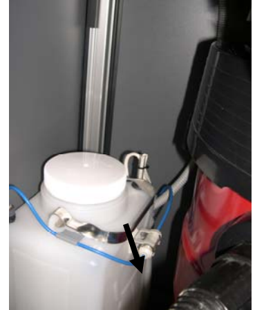
Depósito externo de refrigerante de 2 galones (90938)
