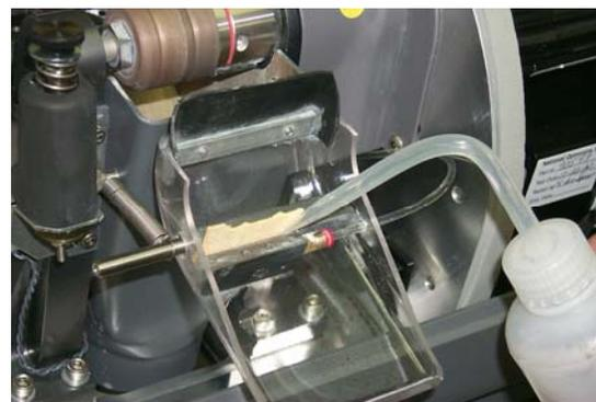
12. Desça a tampa do coletor de aparas e o conjunto da esponja sobre as rodas de polimento. Assegure-se de que os pontos da esponja se encaixam nas ranhuras do bisel das rodas de polimento. (Caso não se verifique, desloque a esponja até que estes se encaixem.)
