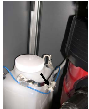
Réservoir à liquide de refroidissement externe 7,5 litres (90938)
