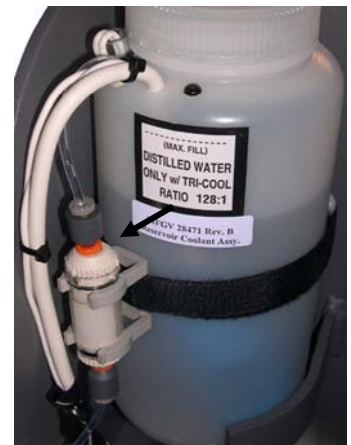
Réservoir à liquide de refroidissement interne 1000 ML (28471)
