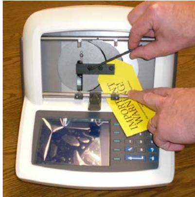
3. Con la llave de tuercas hexadecimal de 9/64 pulgadas, quitar los tres tornillos en el soporte de envío convirtiéndolos hacia la izquierda hasta que los tornillos sueltos
