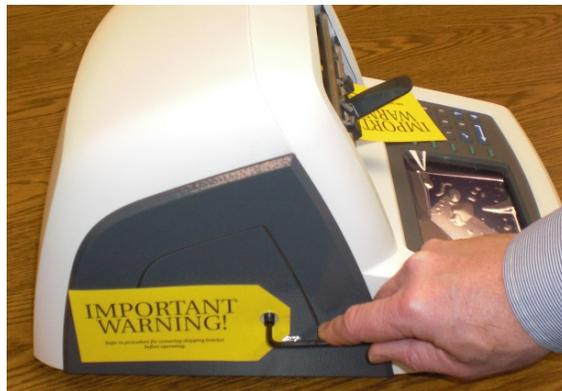
5. Coloque el soporte de envío y el hardware en el Kit de accesorios de trazador para uso futuro posible.
