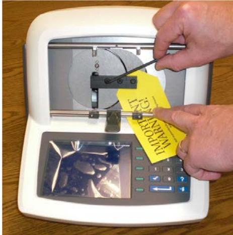
3. Deslice el carro hacia la izquierda y, con la ayuda de llave hexagonal de 5/32", coloque los tornillos Allen de cabeza redonda de 10-32" x 2" con una arandela plana N.º 10.
